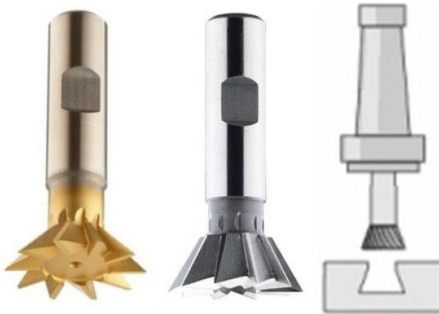
شكل رقم ٨٧: سكاكين دوفتيل (زاويه) Dovetail Cutter
