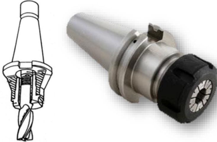
شكل رقم ٣٧: سكينه طرفية ذات حدود قطع يمينية
