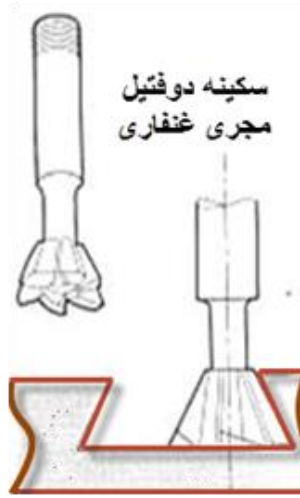
شكل رقم ٩٠: تفتيح المجرى حسب الأبعاد المجرى
