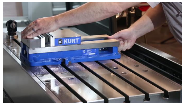
شكل رقم ٩٦: وضع المنجلة على طاولة العمل
