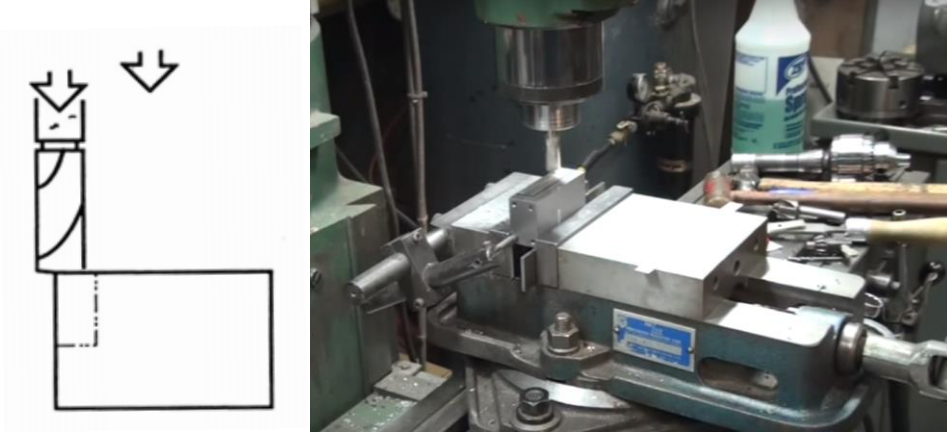
شكل رقم ٣٨: ملامسة جانب الشغلة بسكينه القطع
