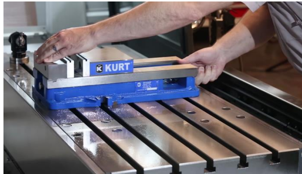
شكل رقم ٢٩: وضع المنجلة على طاولة العمل
