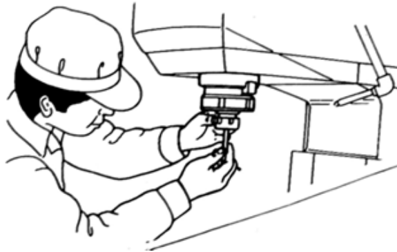
شكل رقم ١٢٥: تركيب سكينه القطع
