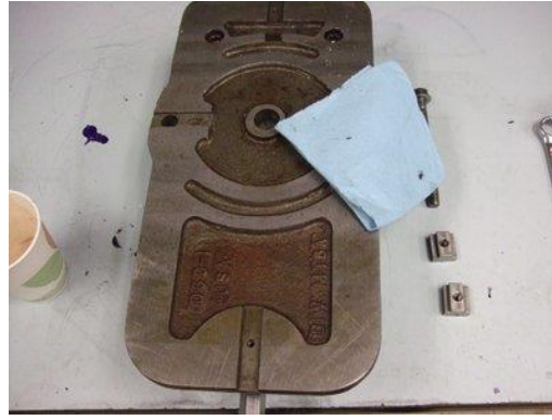
شكل رقم ٩٤: تنظيف طاولة المنجلة
