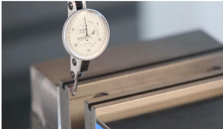
شكل رقم ٣٣: تفسير قيمة مؤشر الأنديكياتور
