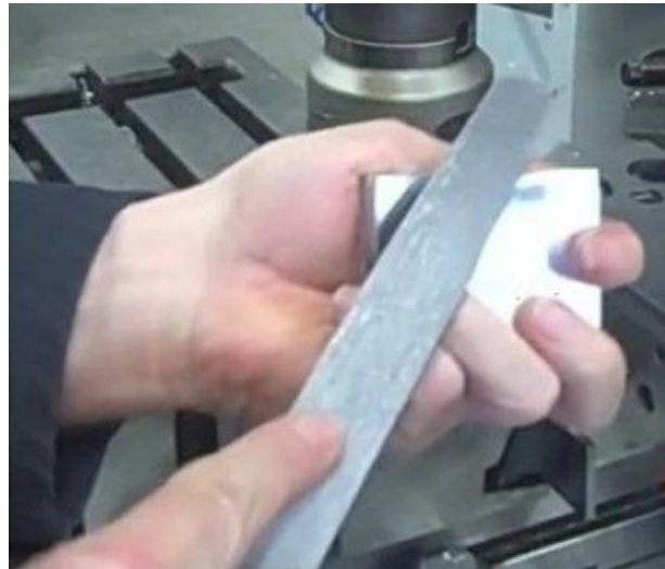
شكل رقم ١١٦: تنظيف الريش بمبرد ناعم
