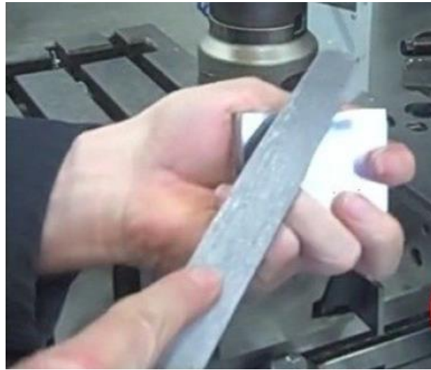
شكل رقم ٥٤: تنظيف قطعة العمل
