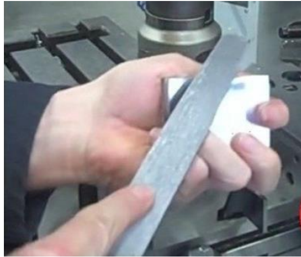
شكل رقم ٨٥: إزالة الأحرف الحادة بمبرد ناعم
