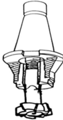
شكل رقم ٨١: تركيب سكينه عمل مجرى حرف T
