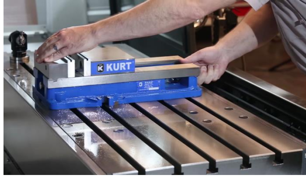
شكل رقم ٦٥: ضع المنجلة على طاولة العمل
