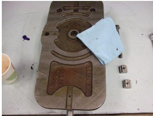
شكل رقم ٢٧: تنظيف طاولة المنجلة
